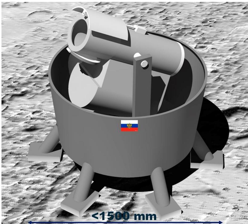
Рис. 13. Общий вид комплекса СОРТ-300К на поверхности Луны без солнечных батарей и двигателей мягкой посадки.
