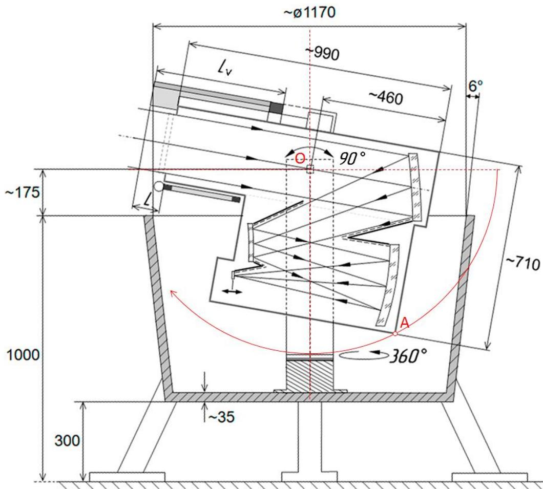
Рис. 12. Продольный разрез комплекса НА СОРТ-300К и его габаритные размеры.
