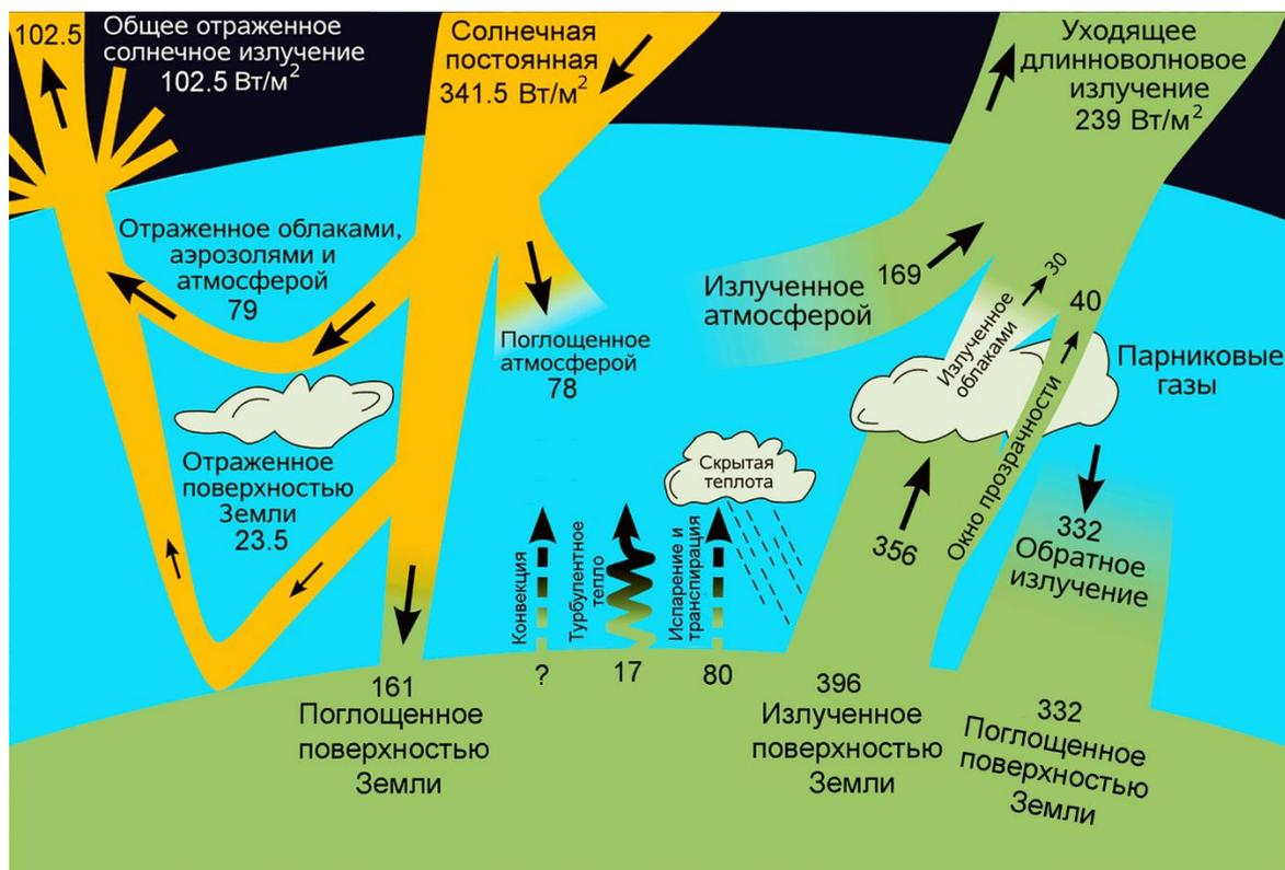
**Рис. 2.** Поступающие и уходящие глобальные удельные потоки энергии на внешней границе атмосферы в равновесном состоянии среднегодового энергетического дисбаланса Земли.
