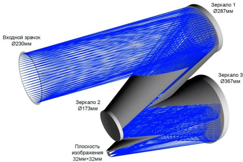
**Рис. 6.** Оптическая схема СОТР-300К с противозасветочными блендами. Трассируются 4 пучка лучей, соответствующие крайним точкам на изображении, заполняющие входной зрачок телескопа.
