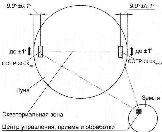
**Рис. 7.** ЛО – система двух близнецов СОТР-300К для измерения комплекса глобальных климатических параметров Земли непрерывно только в лунное ночное время в течение более 94% времени лунных суток.
